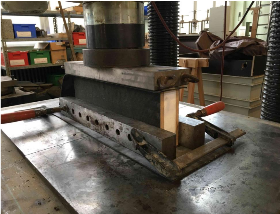
Abb. 1: Bodeneinstandsprofil bei der Druckprüfung
